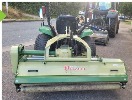
Broyeurs à axe horizontal STARK KM 175 largeur de coupe 1,75m. Cet équipement sera monté sur le petit tracteur fiat, pour tondre les grandes surfaces. Coût 2 800€
