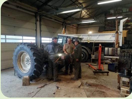
La réparation du tracteur Renault (remplacement du synchro de l'inverseur) a été réalisée intégralement par les agents municipaux, avec le soutien technique de Monsieur Jean Paul BOUCHET. Gain de la réparation de 4000€ par rapport aux devis de professionnels. Coût de la réparation moins de 2000€. Depuis le tracteur avec le broyeur d'accotement ont été vendus pour la somme de 7500€.
